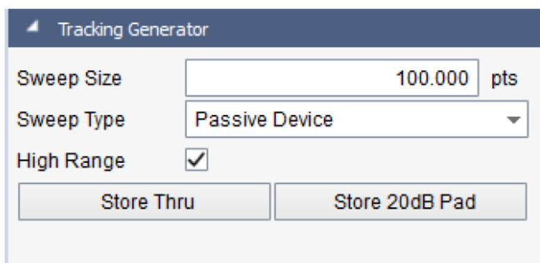
Рисунок 12. Панель управления процессом измерения АЧХ.
